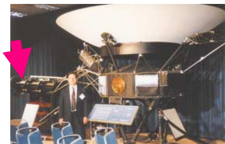
<図7> ポイジャー惑星間探査機(モックアップ)に組込まれている熱電発電機(ジェット推進研究所にて)
